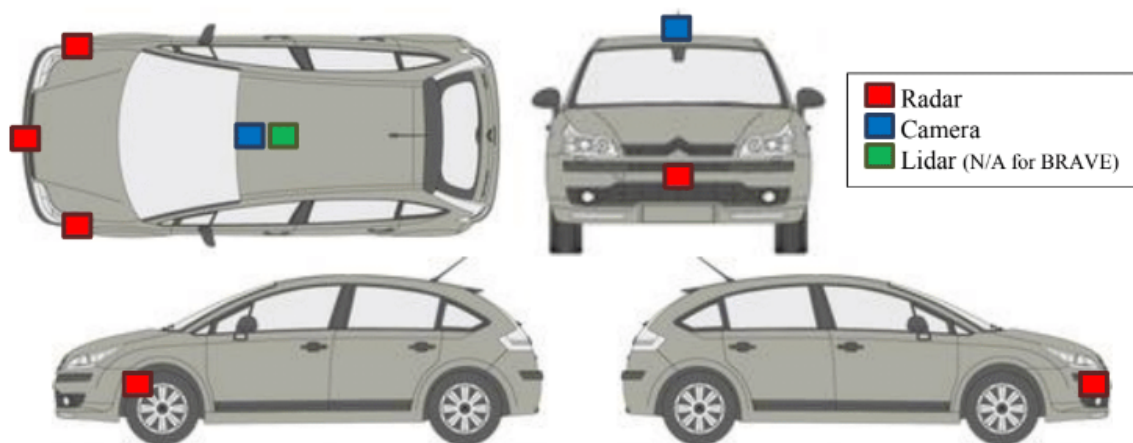
FIGURE 71 VEHICULE EXPERIMENTAL PROJET BRAVE ET LOCALISATION DES CAPTEURS
