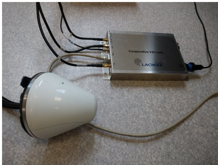
FIGURE 11 L'UNITÉ EMBARQUÉE EN VÉHICULE (UEV)
