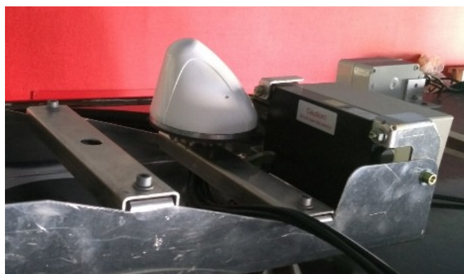
FIGURE 35 MODULE D'ANTENNES DE L'UEV SUR LE TOIT DE LA NAVETTE
