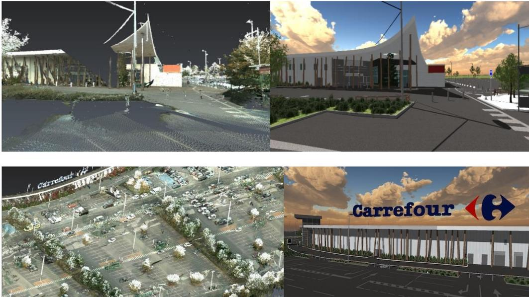
Figure 3 Rendu du nuage de points colorisé à gauche et reconstruction 3D à droite
